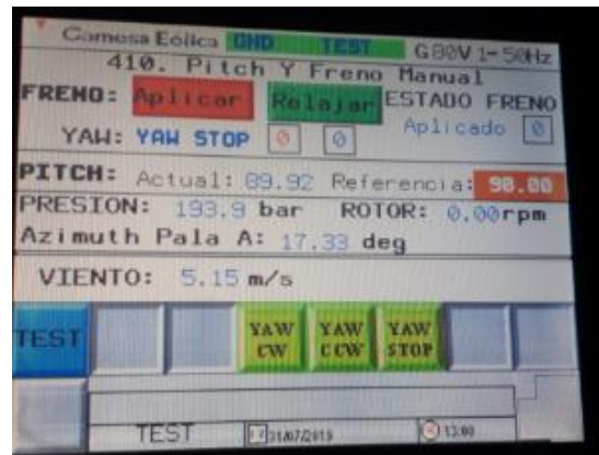
Pantalla de la consola mostrando 'freno aplicado' / Display screen shows 'apply brake'
